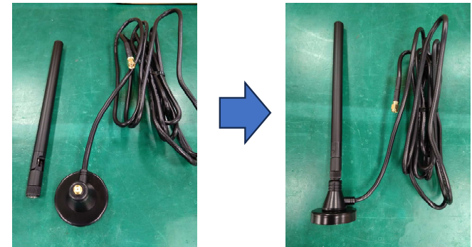
外付けロッドアンテナの組立
